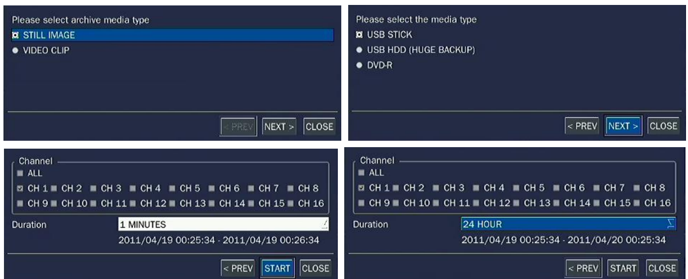
Рисунок 7.2.1. Архивирование видео и экран резервного копирования
