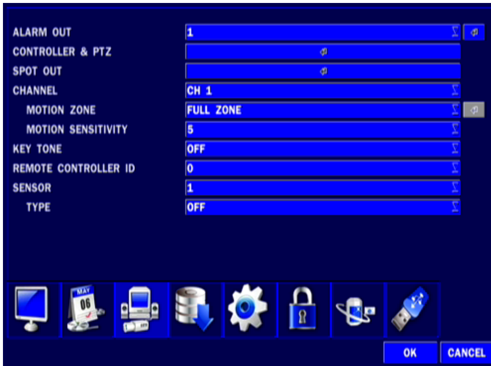
Рисунок 3.4.1. Экран настройки режима устройства
